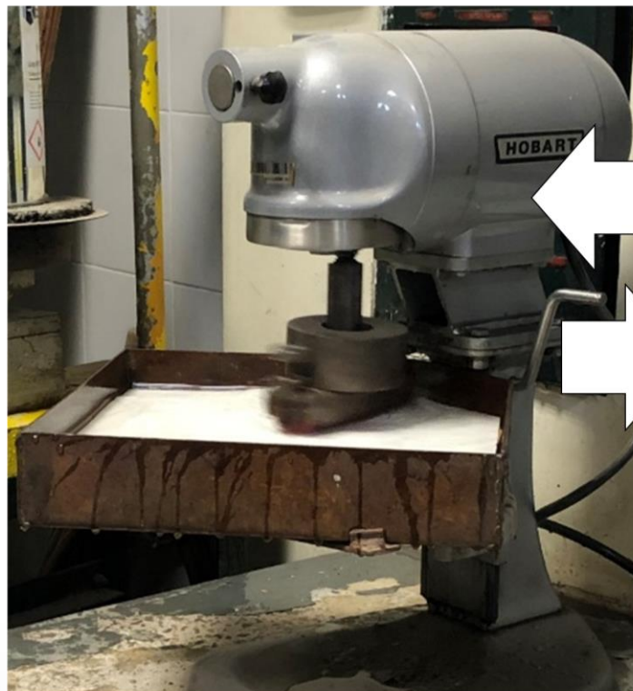
AGITADOR MECANICO Hobart-N50 Ensayo de abrasión en pista húmeda de lechadas asfálticas
